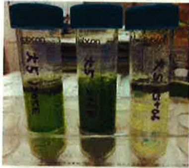
図4. 培養した Chlorella sp. への凝集剤の効果観察。右端の高分子カチオン凝集剤では、ほとんどの藻体が凝集し、浮上することが判った。
