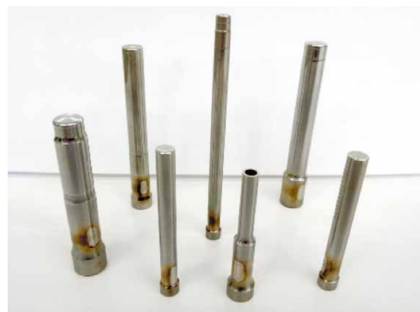
図2 開発した硬質膜(銀色)を被覆した塑性加工用金型
