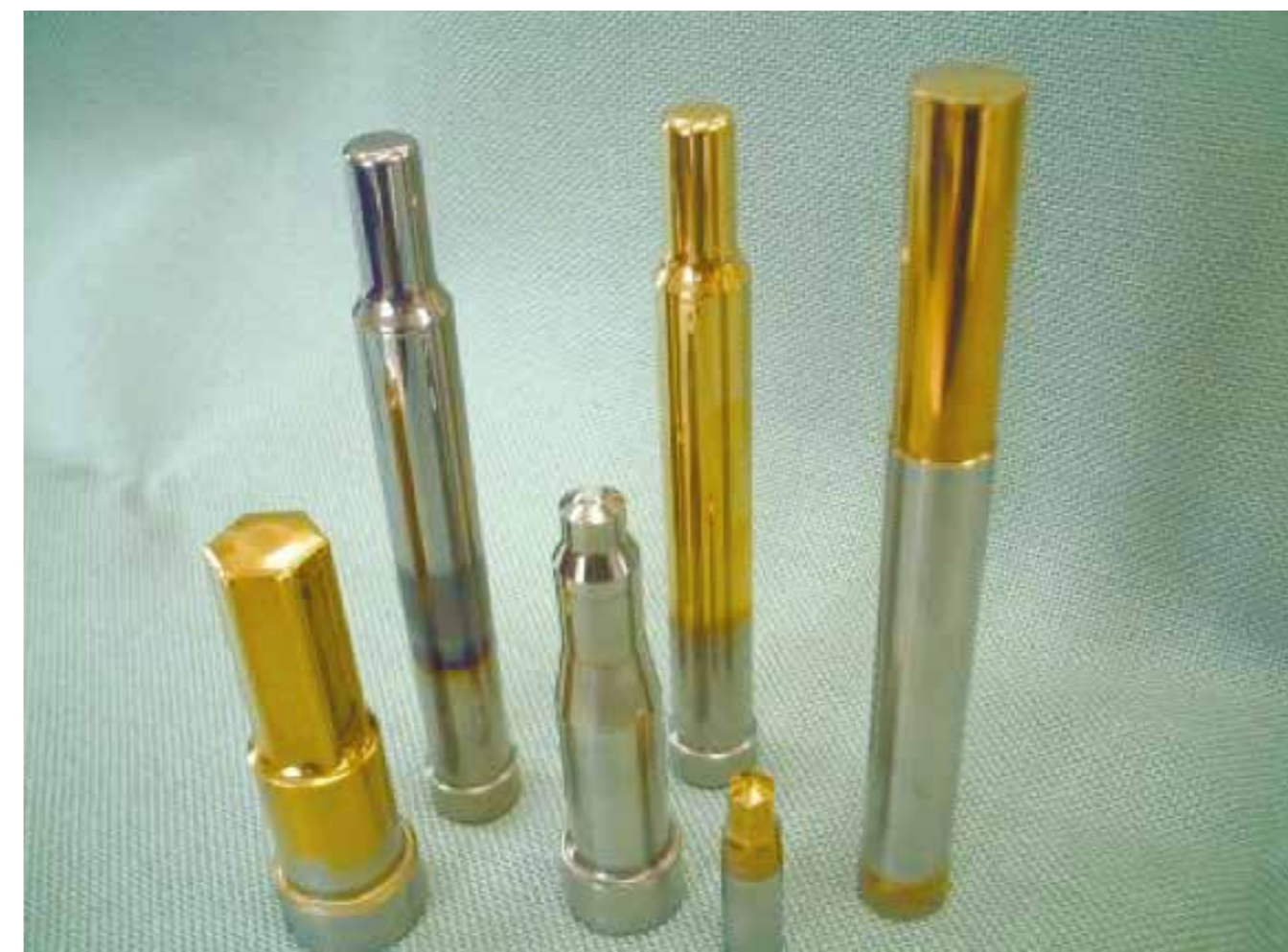
図1 塑性加工用金型(パンチ)の例(銀色はTiC、金色はTiNを被覆)
